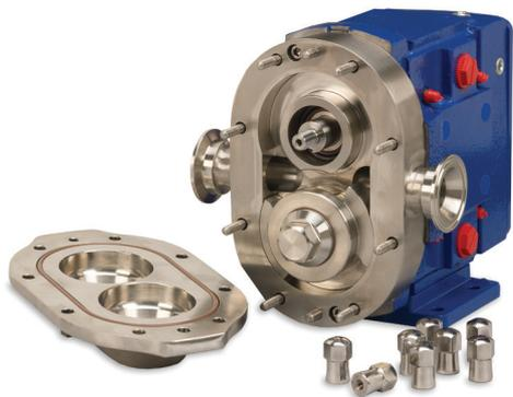
Alfa Laval лопасти роторов (поршни) вращаются по окружности канала в кожухе насоса. Это постоянно создает частичный вакуум во всасывающем отверстии, роторы расцепляются, заставляя жидкость поступать в насос. Жидкость перемещается по каналу лопастями ротора и вытесняется, когда лопасти ротора снова зацепляются, образуя давление в выпускном отверстии. Направление потока можно менять.
